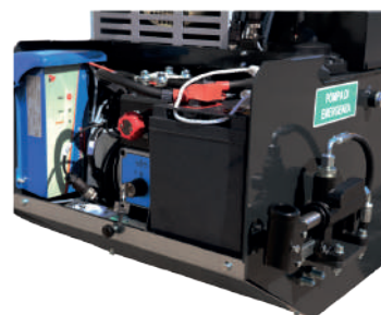
Pompe de secours manuelle et compartiment contenant la batterie et le contrôle de l'électro-pompe de secours et de la connexion de la batterie
