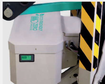
Compartiment batteries lithium : protégé et facilement accessible pour la gestion du cycle de charge. Écran LCD pour vérifier l'état de charge et le temps restant de la batterie
