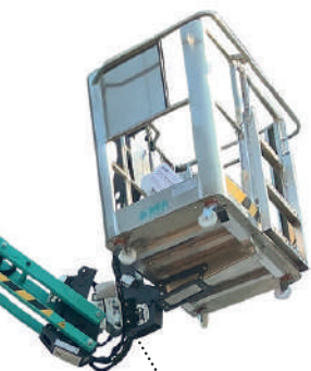
Système de montage du panier conçu pour un démontage facile
