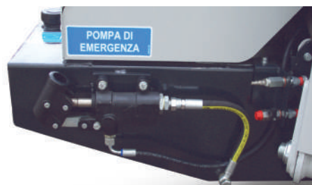
Pompes d'urgence manuelle et électrique facile d'accès et d'utilisation
